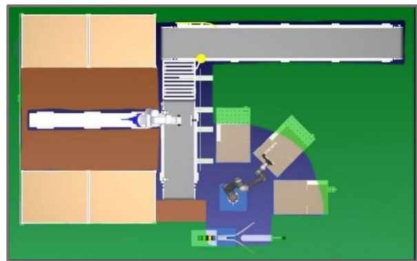
Figura 5.6: Zonas de intersección entre robots.
