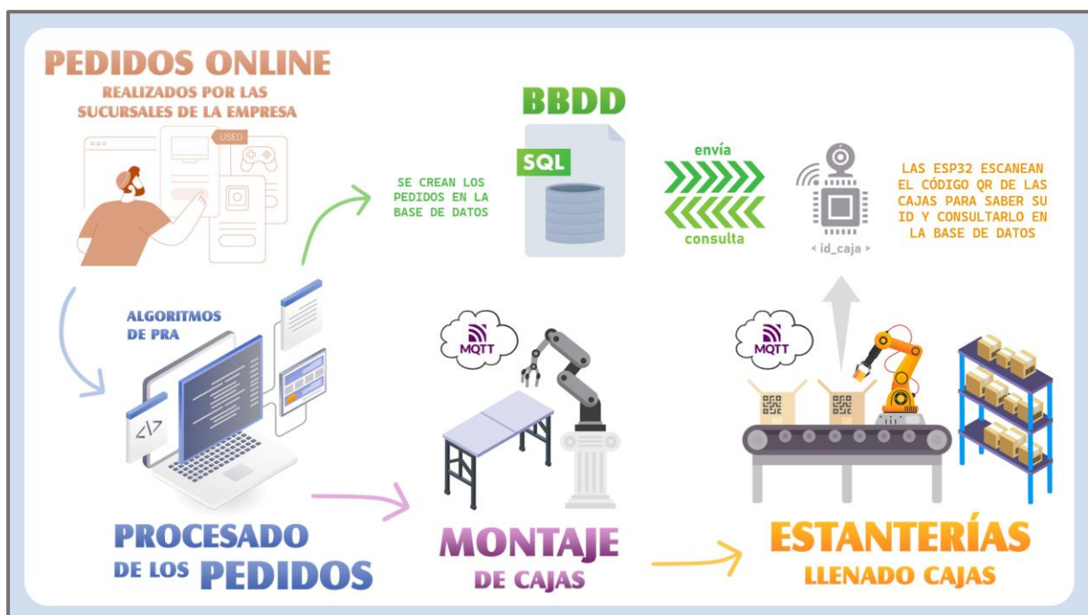
Figura 3.41: Esquema simplificado del proceso de preparación de pedidos automatizado.
